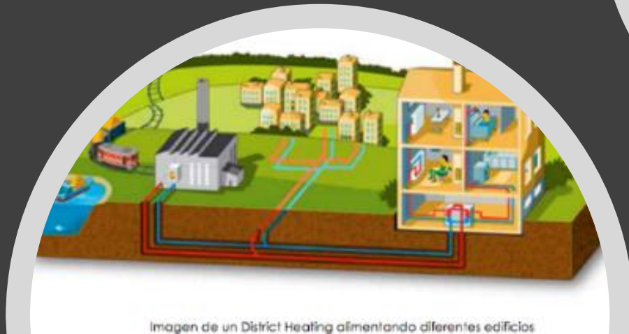
Imagen de un District Heating alimentando diferentes edificios
