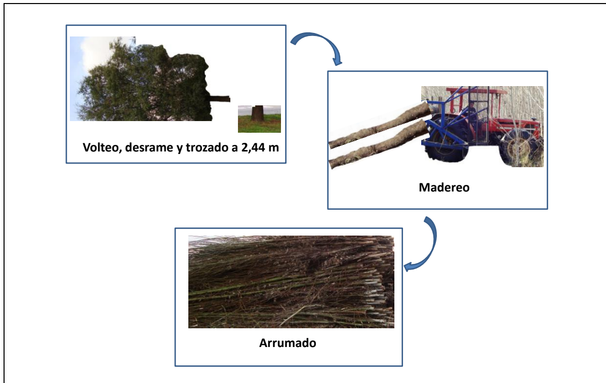
Figura 30. Esquema de producción de trozos para astillado.
